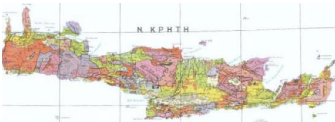
Εικόνα 8.1: Απόσπασμα του γεωλογικού χάρτη της Ελλάδος σε κλίμακα 1:500.000. Με κίτρινες και πράσινες αποχρώσεις απεικονίζονται οι λεκάνες Νεογενούς και του Τεταρτογενούς περιόδου (Μπορνόβας και Ροντογιάννη-Τσιαμπάου, 1983)
