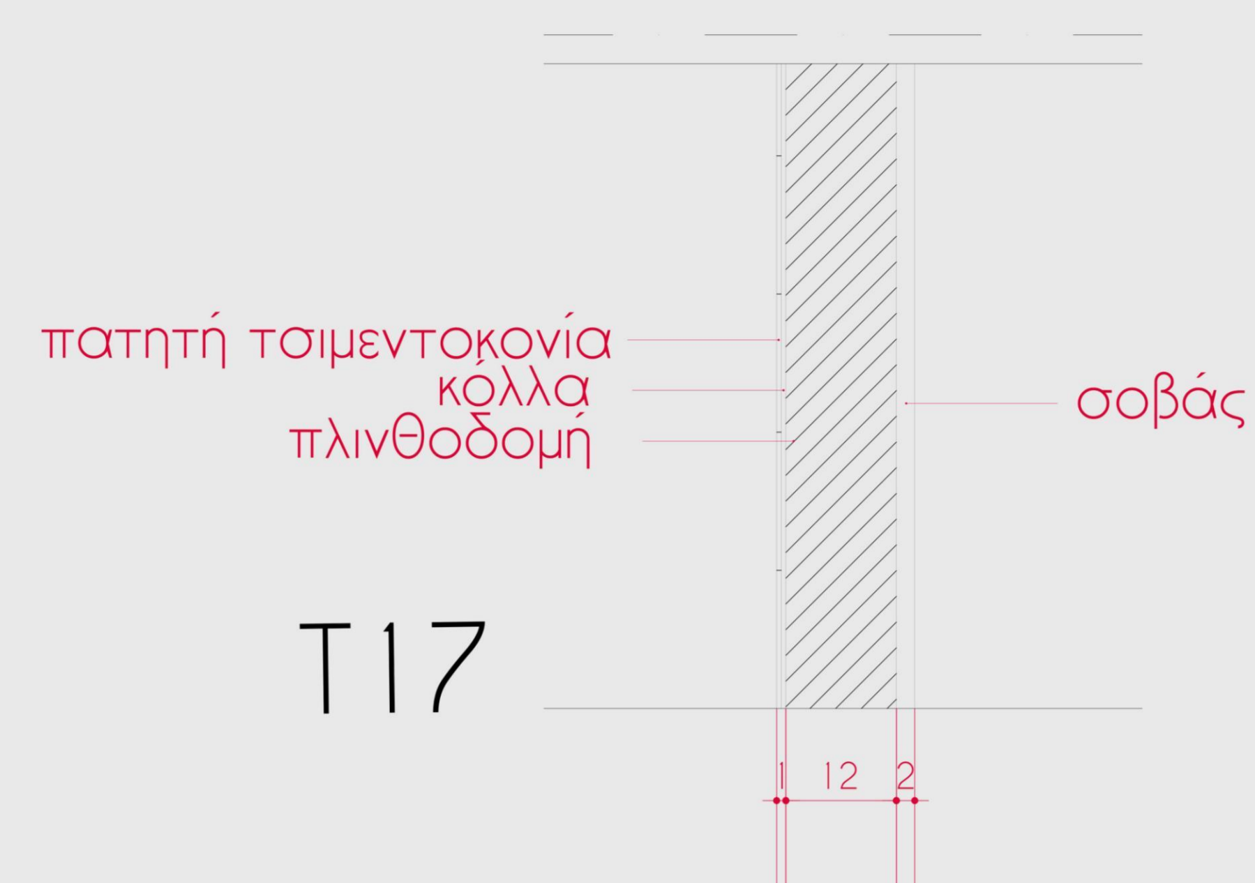
τοίχος πλινθοδομής με επένδυση σοβά και πατητή τσιμεντοκονία
